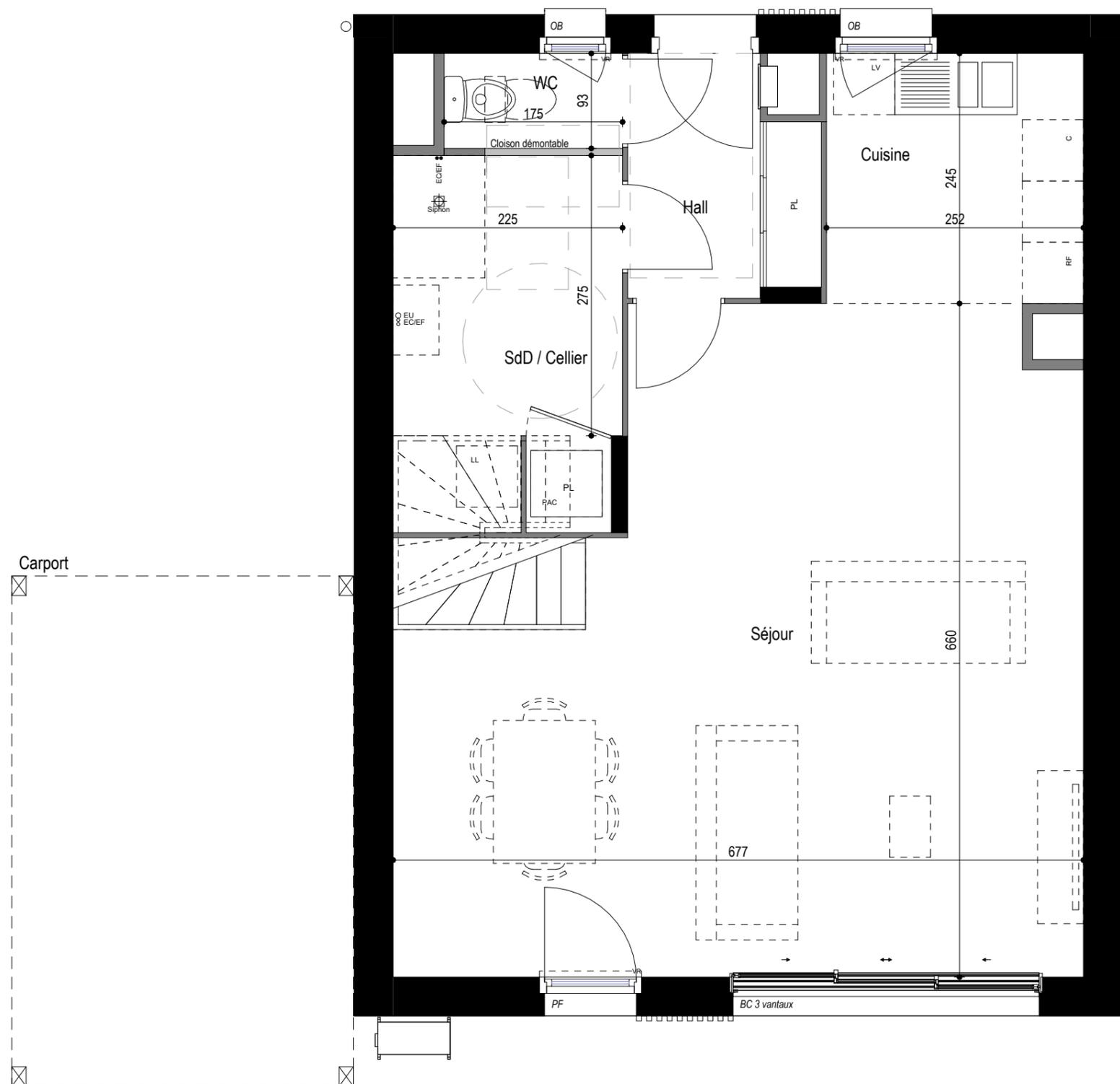
C : Cuisson, LV : Lave vaisselle, LL : Lave linge, RF : Réfrigérateur, OB : Oscillo-Battant, PF : Porte Fenêtre, OF : Ouvrant à la française, VR : Volet Roulant, Tableau électrique
