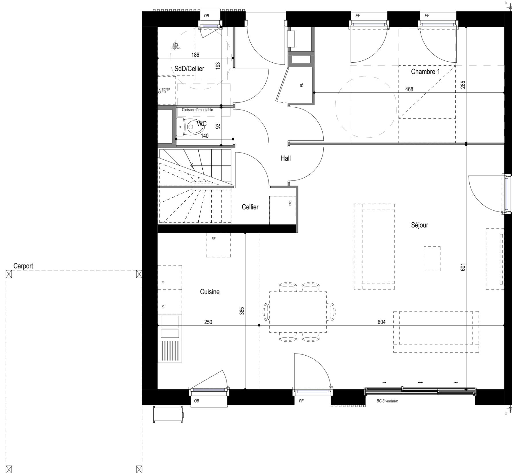
C : Cuisson, LV : Lave vaisselle, LL : Lave linge, RF : Réfrigérateur, OB : Oscillo-Battant, PF : Porte Fenêtre, OF : Ouvrant à la française, VR : Volet Roulant, Tableau électrique
