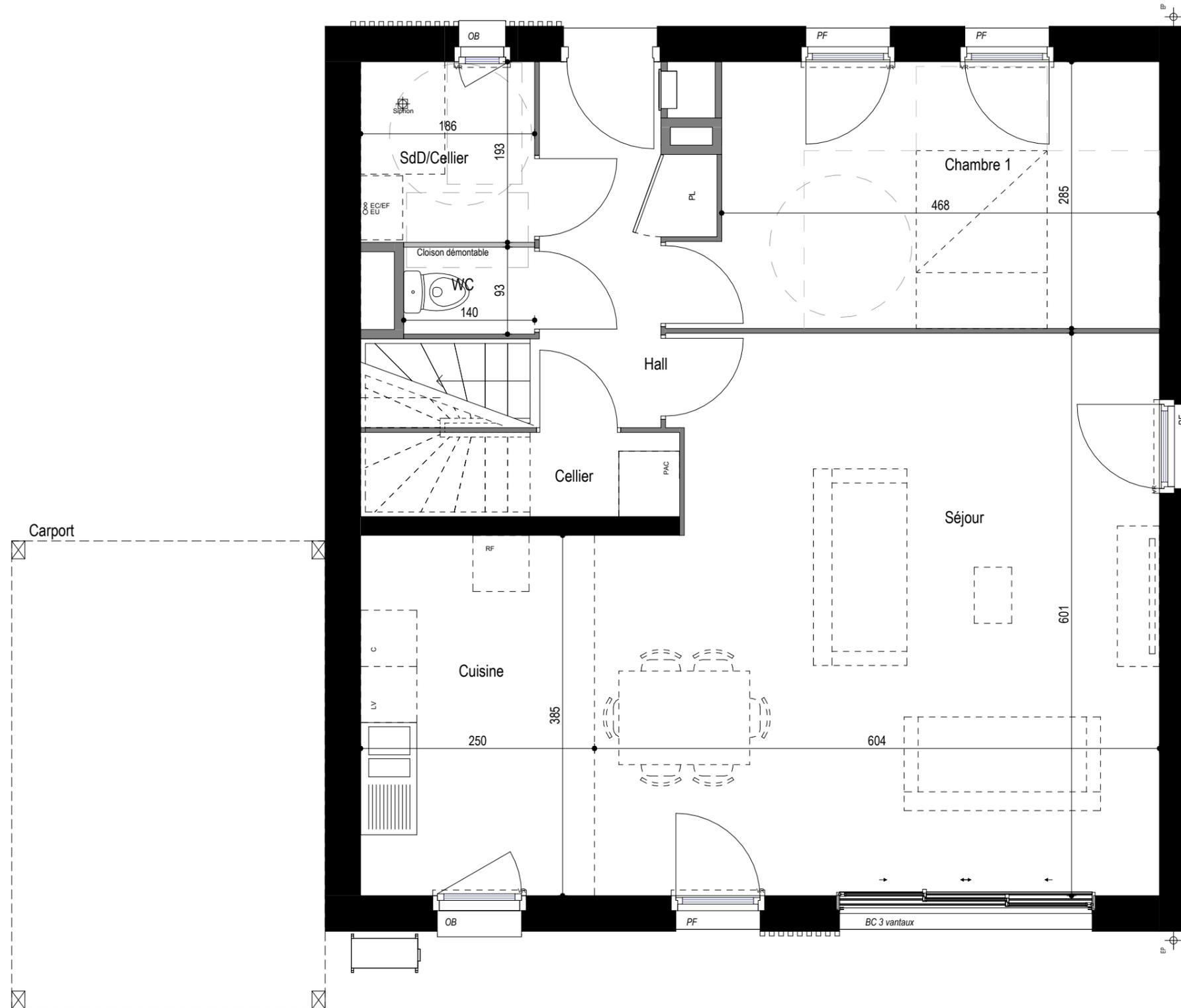
C : Cuisson, LV : Lave vaisselle, LL : Lave linge, RF : Réfrigérateur, OB : Oscillo-Battant, PF : Porte Fenêtre, OF : Ouvrant à la française, VR : Volet Roulant, Tableau électrique
